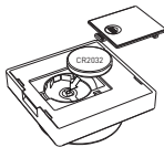
Рис. 1. Установка элемента CR2032 в панель
