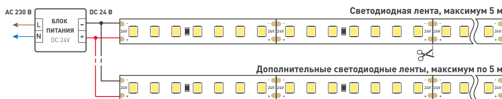
Рис. 1. Подключение нескольких светодиодных лент с одной стороны
