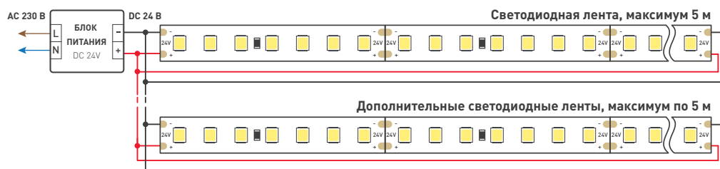
Рис. 2. Подключение нескольких светодиодных лент с двух сторон
