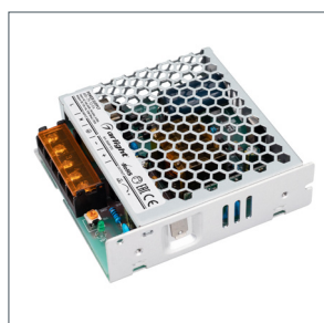
026811(1) | Блок питания ARS-75-12-FA (12V, 6A, 72W)
