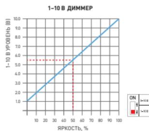
Для режима 1-10 В: если при выходном сигнале 1 В освещение не выключается, необходимо использовать дополнительный выключатель, для отключения нагрузки.
